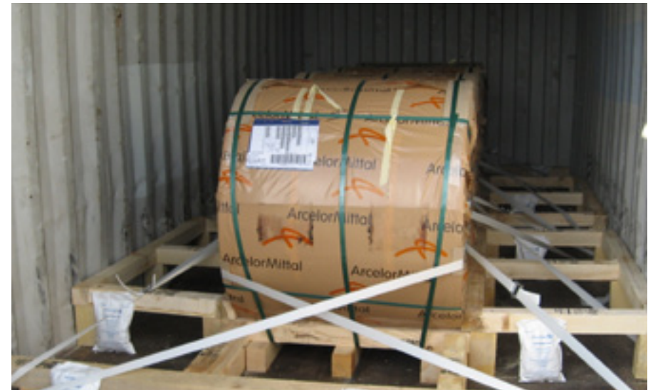
Stahlrolle, mit Achse längs geladen, zur Seite und längs geblockt und mit Nylongurten gesichert
