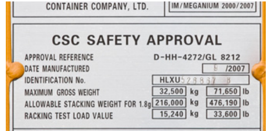
CSC-Plakette eines 20'-Standard-Containers
